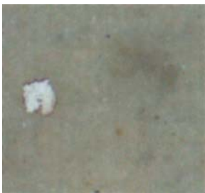
Partícula de metal brilhante tipicamente gerada a partir de uma contaminação interna.
